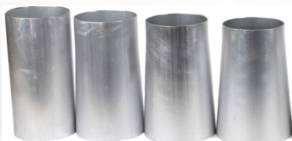
円管を膨張させて円錐型管になる
